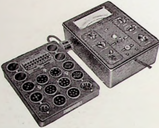
Fig. 1. Avometer, model 7, met 46 meetbereiken en 5-inch schaal met spiegelaflezing. Als voltmeter is de weerstand 20.000 Ohm per volt op alle gelijkstroom bereiken, overeenkomend met een stroomverbruik van 50 micro-ampère bij vollen uitslag.
